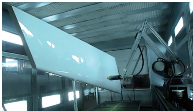
图3 混联机器人用于喷涂飞机两翼 Fig.3 Coating wing with hybrid robot
